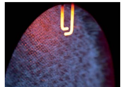
MatriX-Diskbrenner für besonders geräuscharmen und umweltschonenden Betrieb mit einem Modulationsbereich von bis zu 1:6
