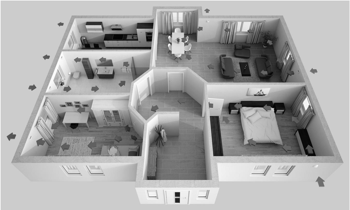
Die dezentralen Lüftungsgeräte mit Wärmerückgewinnung dienen zur Belüftung und Entlüftung von Einzelräumen oder von mehreren Räumen raumübergreifend in Wohngebäuden.
